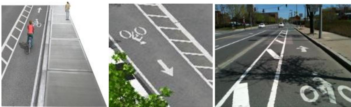
**FIGURE 5-2: EXAMPLE BUFFERED BIKE LANES**
