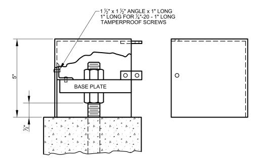
NOTES: BASE COVERS SHALL BE FABRICATED FROM HEAVY GAUGE STEEL.
